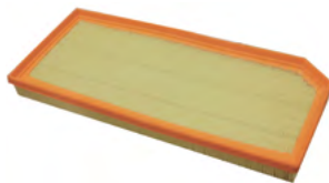
129562 06F/133843/A/ ELEMENTO FILTRO AIRE VENTO/PASSAT 05>08 2.0 -FSI-
